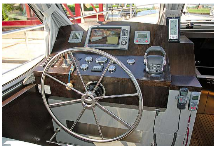
Das stählerne Achtspeichen-Ruder mit 69 cm Durchmesser dominiert die Optik des übersichtlich instrumentierten Steuerstandes
